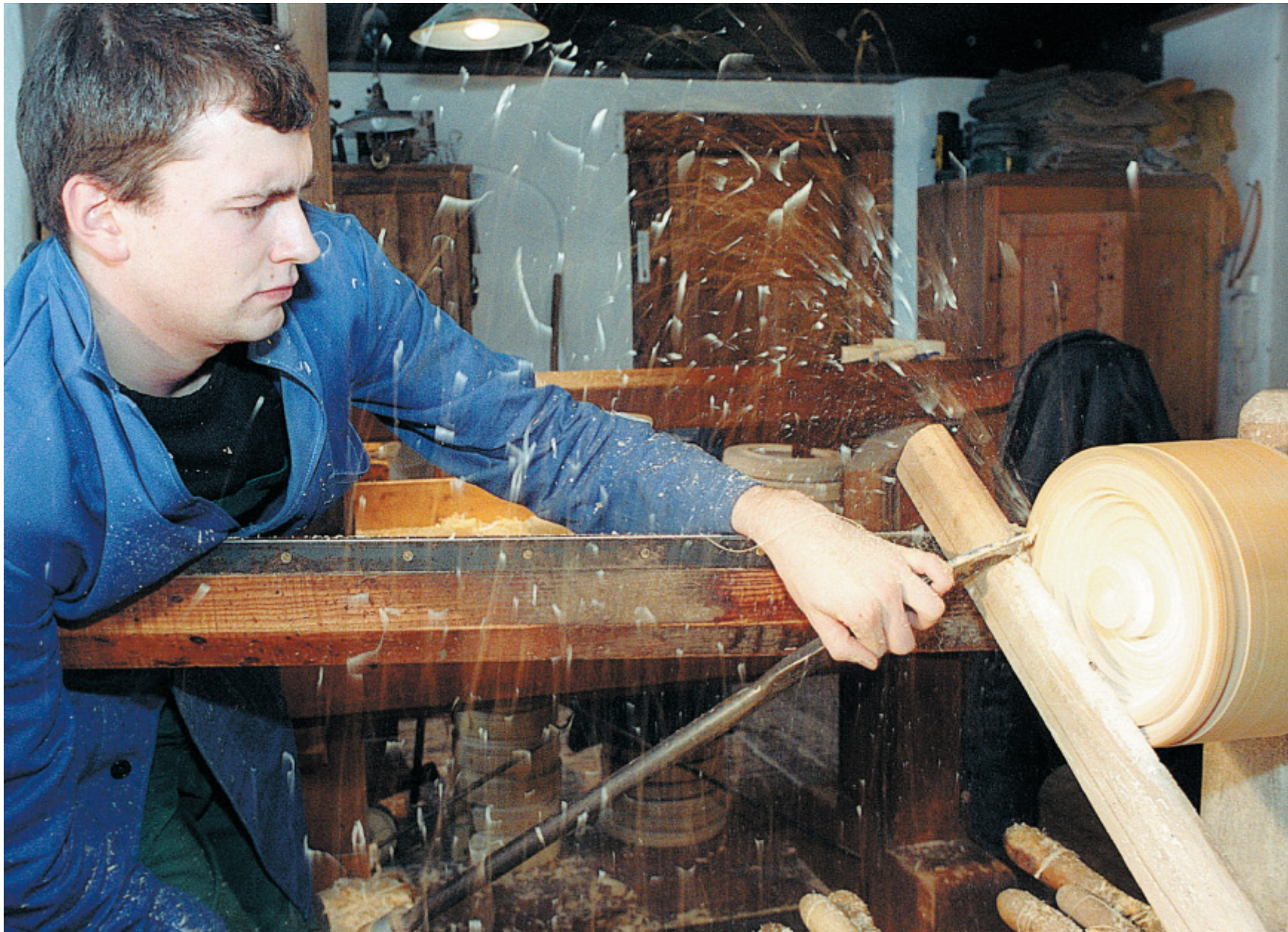
Da spritzen die Späne: Reifendreher Andreas Werner gibt einem Holzring das richtige Profil. Seine Werkstatt sieht noch fast genauso aus wie vor 100 Jahren. Weltweit gibt es nur noch acht Menschen, die dieses Handwerk beherrschen.
